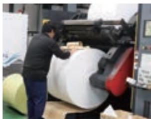
指示書を確認して、用紙と印刷版を印刷機へセットします。用紙はロール状になったものを使用します。印刷版は紙へ転写させるハンコのような役割があります。
